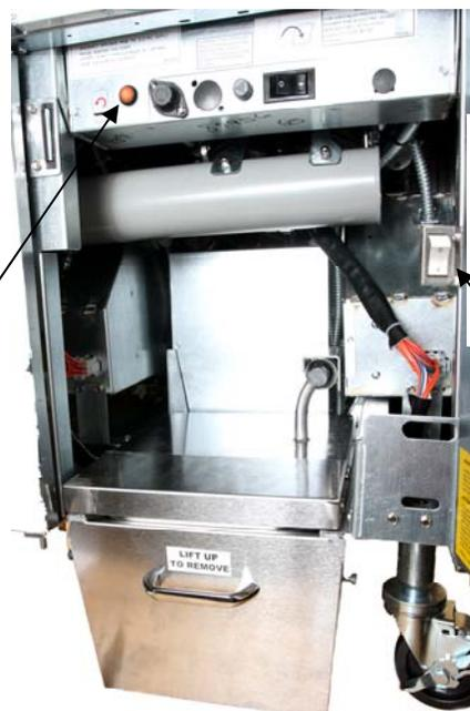
**Figura 4:** O aparelho de melter montado é mostrado na posição.
