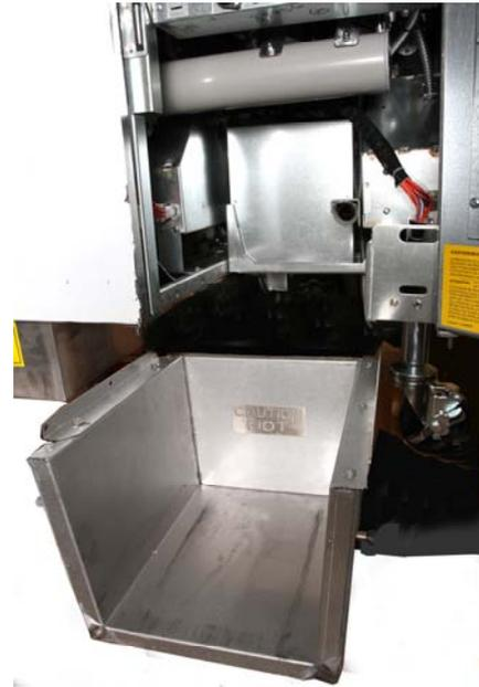
**Figura 1:** Posicione o aparelho de melter no gabinete e prenda com parafusos fornecidos para o interior do armário.
