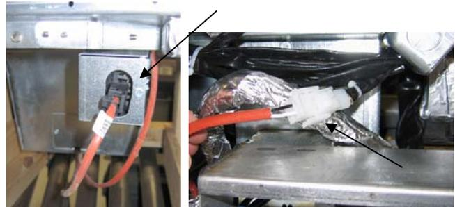
**Figura 3:** Coloque os dois pinos conectores branco e ligar o conector preto na caixa utilidade como mostrado.
